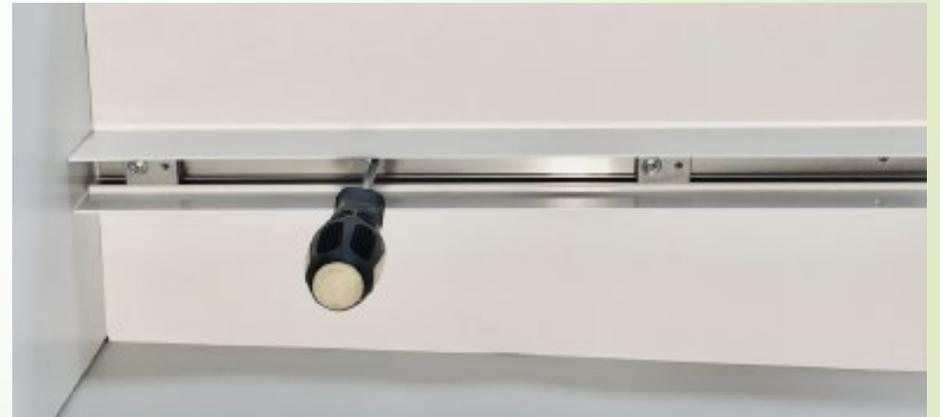
10 – Placer le rail à côté du profil de couverture, assurez-vous que les perçages du rail et du profil se correspondent.
