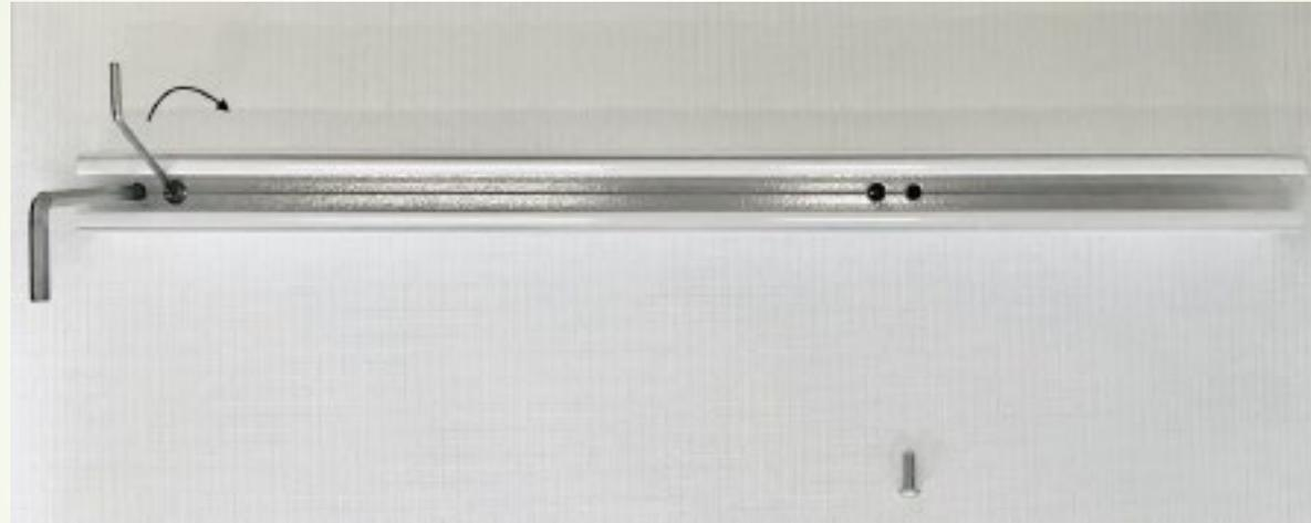
6 - A ce stade, le rail est fixé. Insérer ensuite toutes les vis de réglage, les plats de réglage peuvent bouger de quelques millimètres, utiliser un petit tournevis pour les replacer correctement, en centrant bien les perçages.
